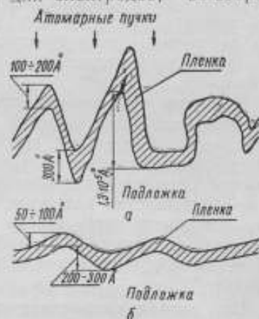
Рис. 7. Схема микрорельефа поверхности подложки с напыленной тонкой металлической пленкой: а — шлифованная поверхность; б — полированная поверхность
