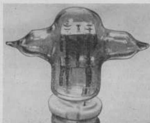
Рис. 6. Готовый кварцевый резонатор с тонкопленочными дисковыми электродами диаметром 10 мм
