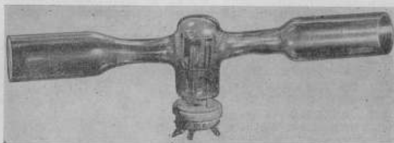
Рис. 3. Колба для нанесения тонкопленочных электродов на кварцевый элемент
