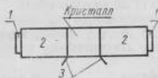
Рис. 3. Схема опыта по обнаружению усиления ультразвука в полупроводниках:
