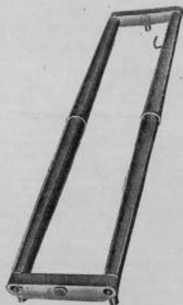
Рис. 3. Установочная мера новой конструкции размером 1000 мм.
