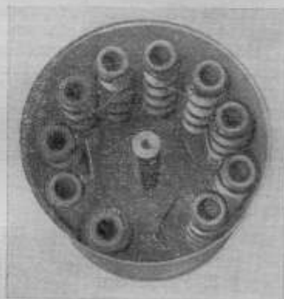
Рис. 6б. Образцовая катушка сопротивления (вид без дна). В центре расположен алюминиевый стержень, внутри которого имеется канал для ртутного термометра
