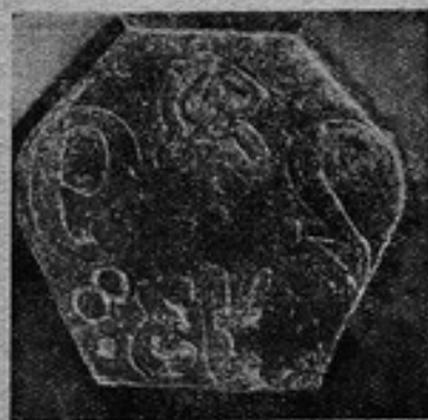
Рис. 3. Микроснимок искаженного пунсона с полным опусканием рельефа в массу пунсона. Неоднородная сталь слабой закалки. Твердость по Шору 60.
