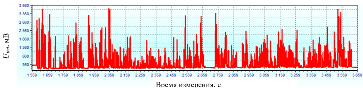
Рисунок 2 – Типичный вид кривой мониторинга показаний индикаторной системы во время определения содержания тиосульфата натрия.
