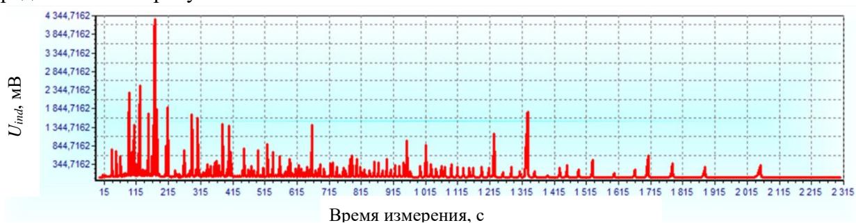
Рисунок 3 – Типичный вид кривой мониторинга показаний индикаторной системы во время основного этапа определения массовой доли йодата калия.
